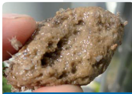
Partícula de relleno con biopelícula de una instalación similar | Filter media particle with biofilm from a similar facility
